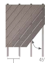
Fig. 2 Inclinazione del pavimento a 45°
